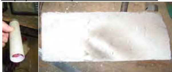
... contenant un «étui » de fer à souder en amiante et une plaque d'amiante (pour les travaux de soudure)
