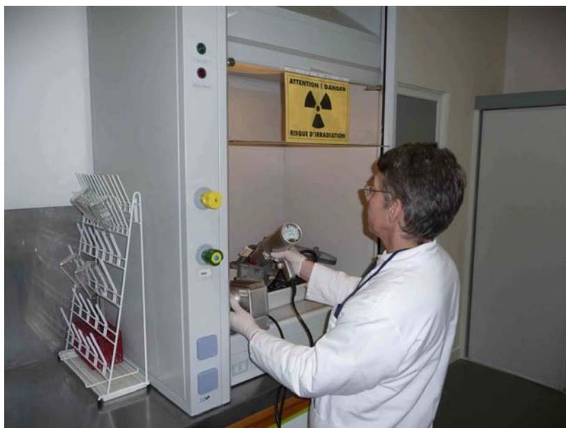
Mesure de flux de rayonnement gamma au moyen du scintillomètre SPP2
