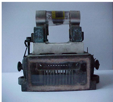
Parasurtenseurs à pointe doublés par des parasurtenseurs à couteaux
